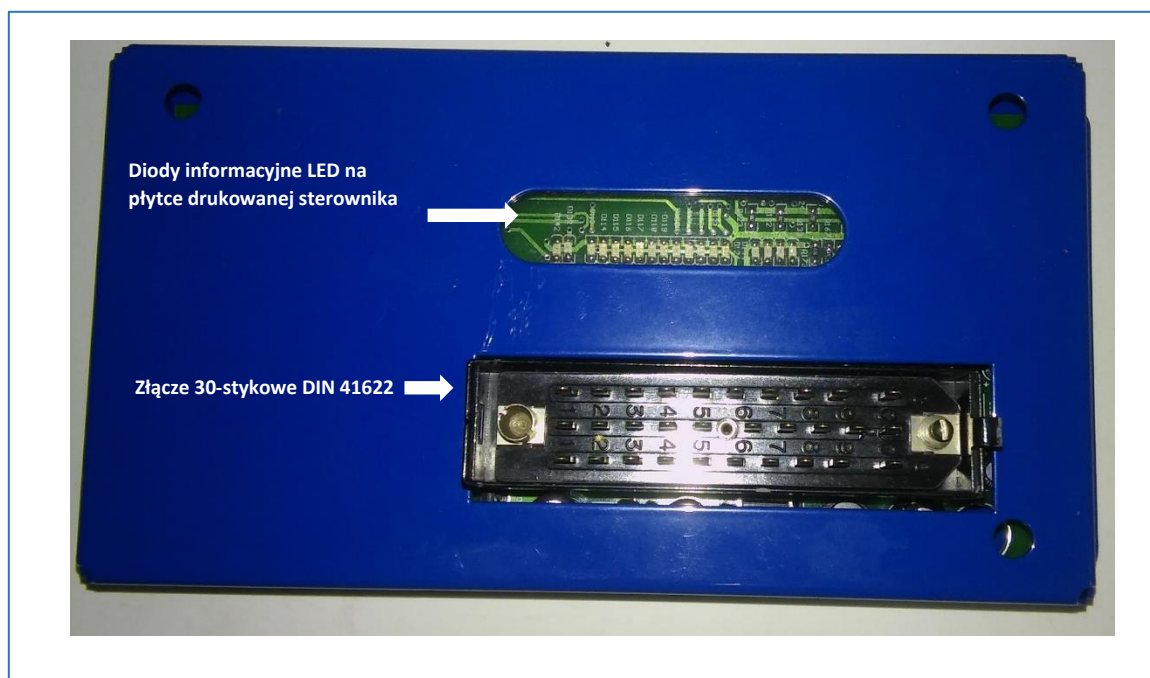
Rys. 1. Sterownik stopni SS24V-1 – widok ogólny
